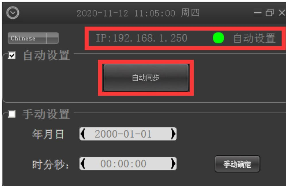
设备插上网线，跟电脑在同一个局域网内，点击自动同步，电脑会自动去同步你的设备时间，图中红框标记是你设备连接正常的 IP 地址；
